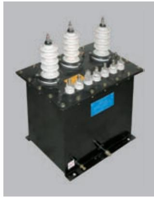
Трансформатор напряжения антирезонансный типа НАМИТ-10-2 является масштабным преобразователем и предназначен для выработки сигнала измерительной информации для измерительных приборов в цепях учета, защиты и сигнализации в сетях 6 и 10 кВ переменного тока промышленной частоты с изолированной нейтралью.
