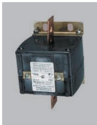
Трансформатор Т-0,66 является катушечным, а трансформатор ТШ-0,66 – шинным. Трансформаторы по принципу конструкции – опорные. Трансформаторы выполнены в пластмассовом корпусе. По специальному заказу возможна поставка трансформаторов в корпусе из самозатухающих пластмасс. Трансформаторы крепятся к заземленным конструкциям изделий потребителей с помощью фланцев.
