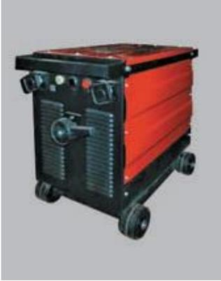
Сварочный выпрямитель типа ВД-309 предназначен для ручной дуговой сварки покрытыми электродами изделий из сталей на постоянном токе. Сварочный ток плавно регулируется с помощью механического перемещения магнитного шунта горизонтального исполнения. Градуировка тока дуги выполнена на внешней поверхности шунта. Оригинальный механизм такого шунтового регулирования резко уменьшает время,
