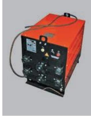
Сварочный выпрямитель ВДМ 2х313 предназначен для двухпостовой ручной дуговой сварки покрытыми электродами изделий из стали на постоянном токе. Выпрямитель отличается простотой и надежностью конструкции, а также отсутствием традиционных балластных реостатов. Сварочный ток регулируется плавно в одном диапазоне с помощью ручного механического перемещения магнитного шунта горизонтального исполнения.
