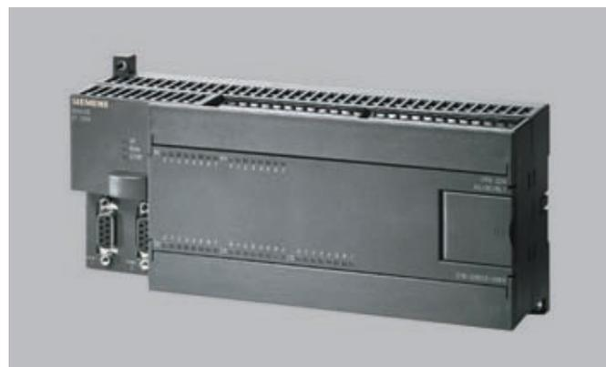
Микро ПЛК SIMATIC S7-200 предназначены для построения замкнутых и разомкнутых систем автоматического управления как отдельных машин, так и небольших технологических процессов. SIMATIC S7-200 позволяют решать широкий спектр задач управления – от замены простых релейно-контактных схем до построения автономных, сетевых и распределенных систем управления.
